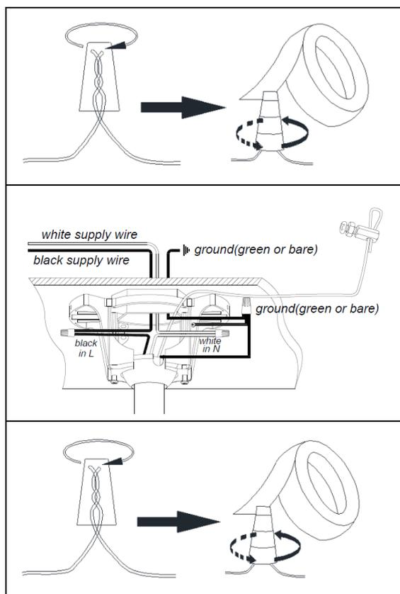
Raccorder le FIL DE TERRE DU LUMINAIRE au FIL DE TERRE DE LA BOÎTE DE JONCTION (normalement l'isolement vert du fil nu) à l'aide du connecteur à coinçeur câblé en plastique (L) et envelopper le raccordement avec du ruban isolant. S'assurer qu'aucun fil n'est exposé.
