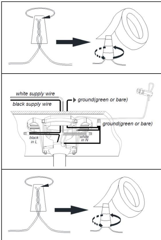
Conectar el CABLE DE CONEXIÓN A TIERRA DEL ARTEFACTO con el CABLE DE CONEXIÓN A TIERRA DE LA CAJA DE CONEXIONES (por lo general el aislamiento verde del cable descubierto) utilizando el conector de tuerca para cables de plástico (L) y envolver la conexión con cinta aislante. Asegurarse de que no quede al descubierto ningún cordón de cable.
