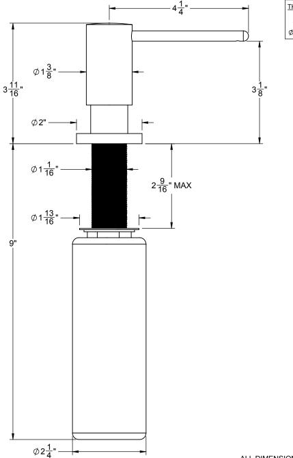
THROUGH-HOLE SPECIFICATIONS <u>MIN</u> RECOMENDED <u>MAX</u> Ø1-1/16" Ø1-1/4" Ø1-1/2
